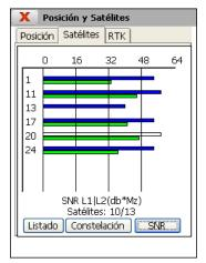
On outre, on peut obtenir information détaillée sur l'actuelle position avec des coordonnées géographiques WGS-84 ou projetées, et les graphiques en temps réel de la constellation de satellites, diagramme de signal/bruit et des informations sur la qualité du lien de données, distance à la base, pourcentage d'ambiguïtés résolues, etc.
